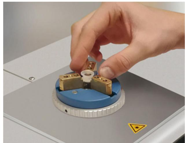
Mittendickenbestimmung einer Mikrolinse mit dem OptiSurf® LTM
